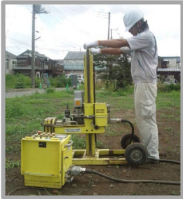
SDS試験 土質(砂・粘土)を調べます。
